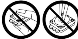
Die REGGIANI LED LUCE nicht berühren. Dies gilt insbesondere für die Berührung mit spitzen Gegenständen, die die internen Anschlüsse beschädigen können.
