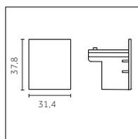
Tête de fermeture pour rail en surface avec vis de fixation
