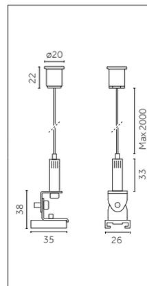
Kit de suspension avec câble de 2 m et système de contrepoids
